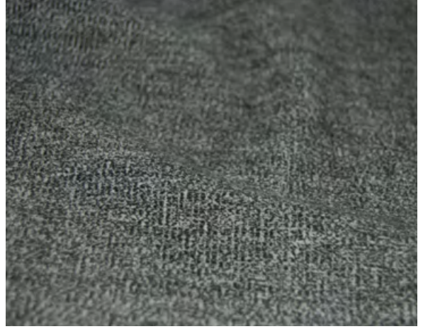
Proje: 6672-2 İçerik: 75% Pamuk/25% Polyester Konstrüksiyon: Fitilli Kadife
