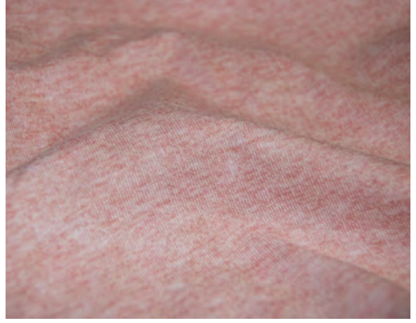
Proje: SK-1739-2 İçerik: 100% Pamuk Konstrüksiyon: Vanize Süprem
