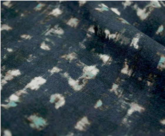
Proje: DK-2810-1A İçerik: 95% Pamuk/5% Elastan Konstrüksiyon: Ponte di Roma
