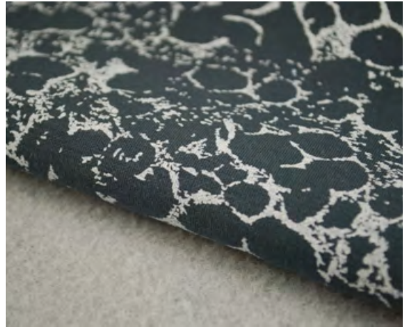
Proje: DK-2813-3B İçerik: %66 Pamuk %20 Elastan %14 Polyester Konstrüksiyon: Çift Yüzlü Kumaş
