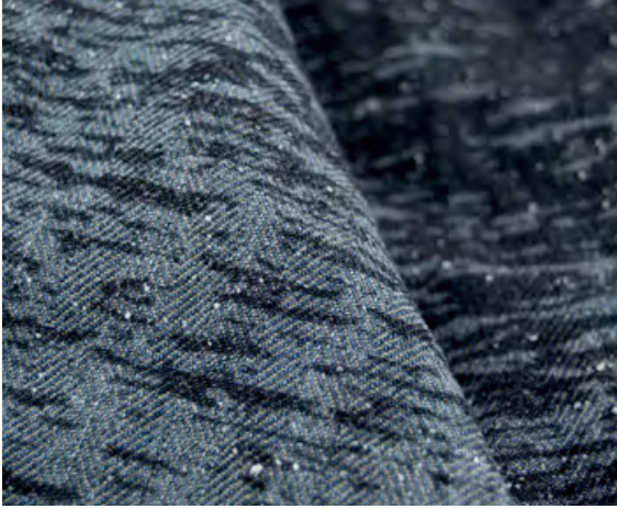
Proje: 7001 İçerik: 100% Pamuk Konstrüksiyon: Balıksırtı
