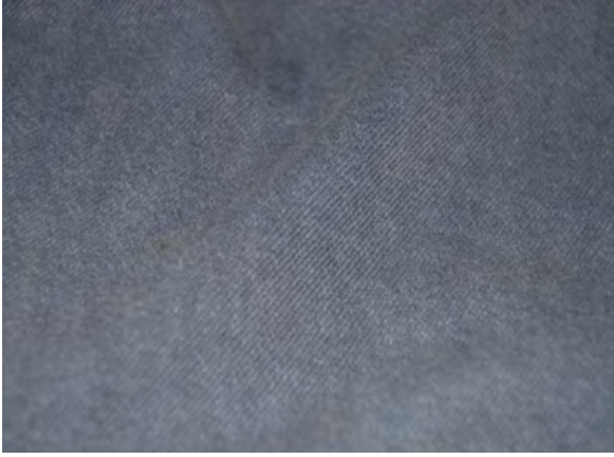
Proje: 6724 A İçerik: %100 Pamuk Konstrüksiyon: Dimi - 3/1 Z Notlar: 40 dakika boyunca ozon ile yıkanmıştır*
