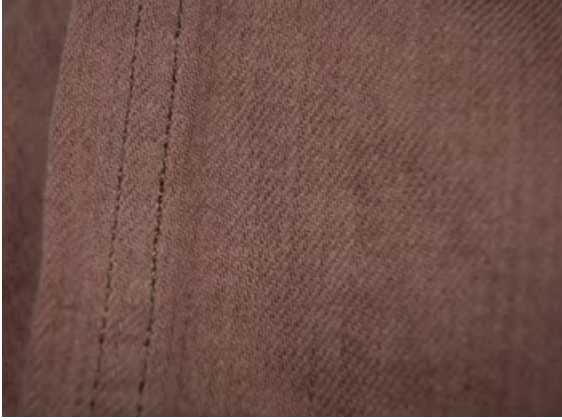
Proje: 6747 A İçerik: %100 Pamuk Konstrüksiyon: Dimi - 3/1 Z Notlar: 30 dakika boyunca ozon ile yıkanmıştır*
