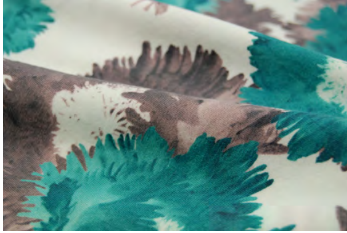
Proje: SK-1987-2A23 İçerik: 97% Pamuk/3% Elastan Konstrüksiyon: Vanize Süprem
