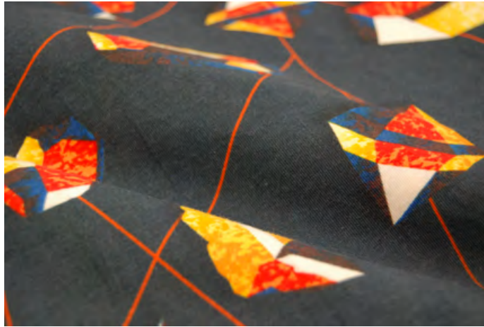
Proje: SK-1987-2A1 İçerik: 97% Pamuk/3% Elastan Konstrüksiyon: Vanize Süprem
