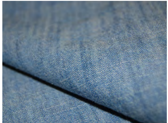
Proje: 6724 B İçerik: %100 Pamuk Konstrüksiyon: Bezayağı Notlar: 110 dakika boyunca ozon ile yıkanmıştır*
