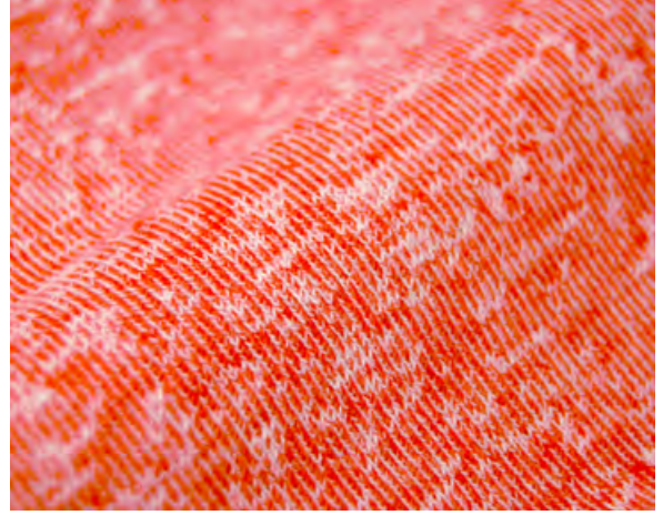
Proje: SK-1903-1 İçerik: 100% Pamuk Konstrüksiyon: Vanize Süprem
