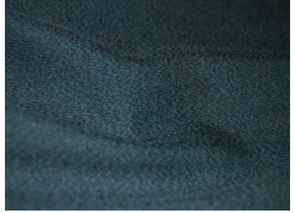
Proje: 5935 İçerik: %68 Pamuk/%32 Kumpramonyum Rayon Konstrüksiyon: Saten - Atkı Yüzde Notlar: Akrilik tabanlı sprej kaplama
