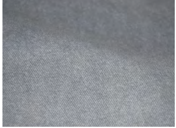
Proje: 6724 B İçerik: %100 Pamuk Konstrüksiyon: Dimi - 3/1 Z Notlar: 65 dakika boyunca ozon ile yıkanmıştır*
