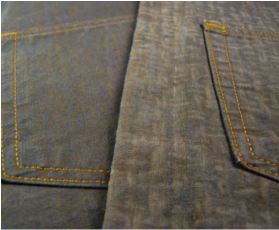
Proje: 7074-4A, 4B İçerik: 100% Pamuk Konstrüksiyon: Bezayağı
