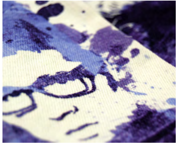
Proje: 6846 L İçerik: 98% Pamuk/2% Elastan Konstrüksiyon: Dimi - 3/1 Z
