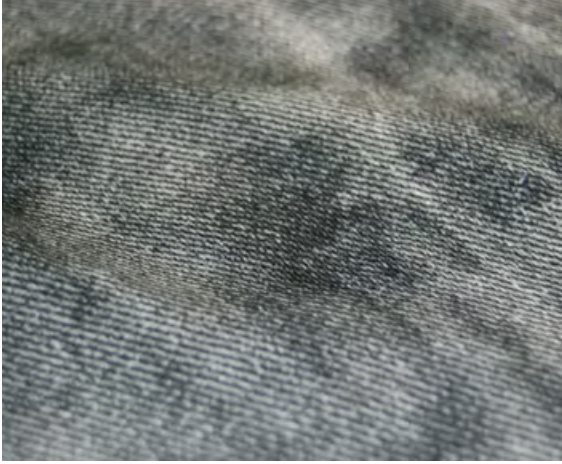
Proje: SK-1867-2CT İçerik: 88% Pamuk/12% Elastan Konstrüksiyon: Vanize Süprem
