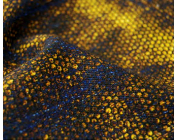
Proje: 6846 X İçerik: 98% Pamuk/2% Elastan Konstrüksiyon: Dimi - 3/1 Z
