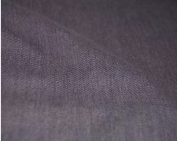
Proje: 6696 İçerik: 98% Pamuk/2% Elastan Konstrüksiyon: Dimi - 3/1 S
