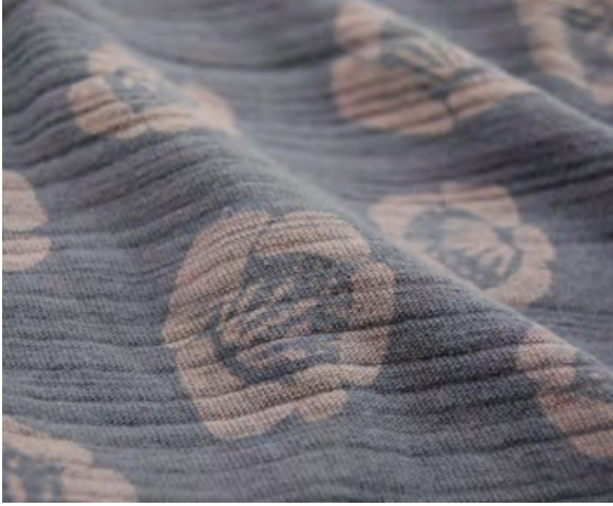
Proje: SK-2016-4 İçerik: 100% Pamuk Konstrüksiyon: Süprem
