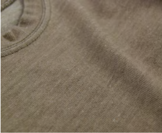
Proje: SK-2055-6E İçerik: 100% Pamuk Konstrüksiyon: Vanize Süprem
