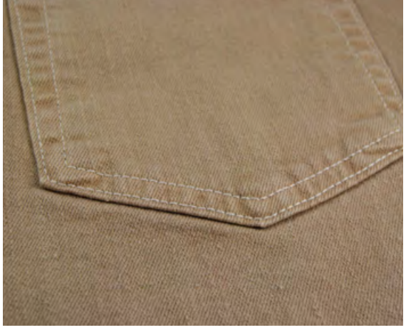
Proje: 7061-2 İçerik: 98% Pamuk/2% Elastan Konstrüksiyon: Dimi - 3/1 Z
