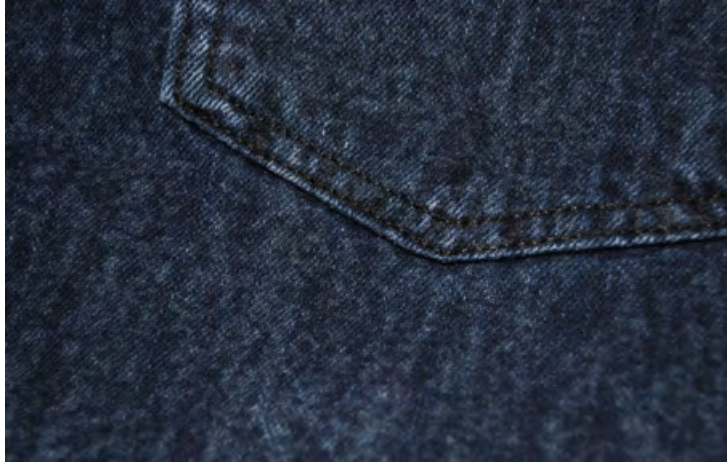
Proje: 7095 İçerik: 98% Pamuk/2% Elastan Konstrüksiyon: Dimi - 3/1 Z
