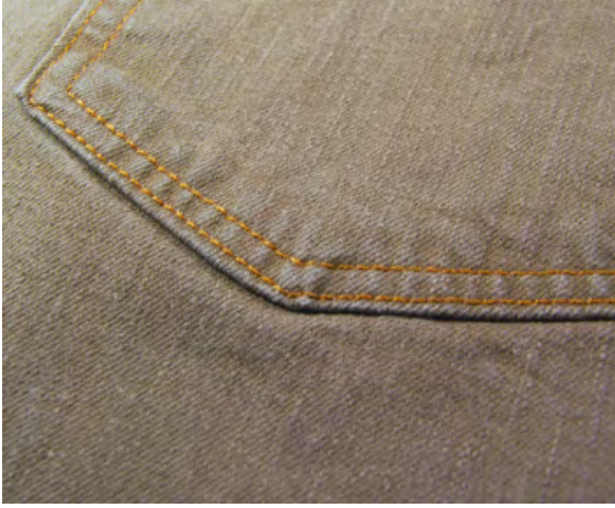
Proje: 7072-2 İçerik: 98% Pamuk/2% Elastan Konstrüksiyon: Dimi - 3/1 Z
