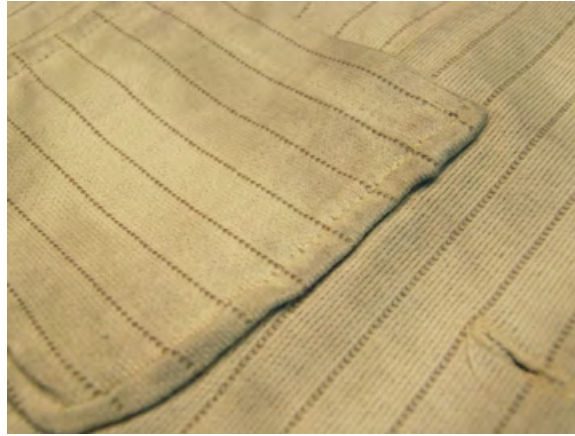
Proje: SK-1998-2 İçerik: %100 Pamuk Konstrüksiyon: İki İplik Notlar: Pigment sprej yapılmış giysi
